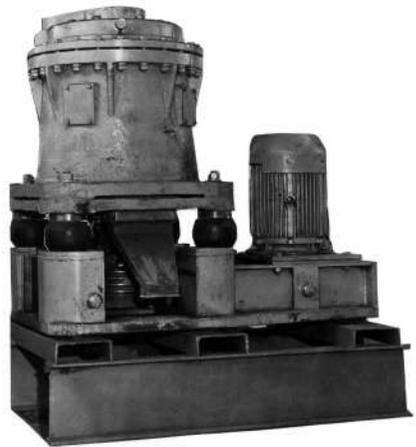
Рис. 3 – Дробилка КИД-450 с виброизоляторами ВР-203
