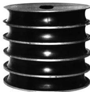
Рис. 4 – Виброизолирующая опора дробилки КИД-2200
